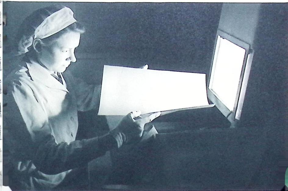
Contrôle : Vérification du film radio sous une lumière frissante.
